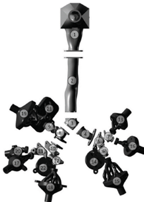
Obr. 1. Umělé plice – segmentární model plic (konstrukce VUT Brno 2019) 21 : 1 – segment s dutinou ústní, 2 – průdušnice, 3 – bifurkace, 3 – levá průduška, 5 – mezičlánek k větvení laloků, 6 – větvení do pravého dolního laloku (14, 15 – větve představující dolní levý lalok), 7 – větvení do levého horního laloku (13, 16 – horní levý lalok), 8 – pravá průduška, 10 – větvení k pravému dolnímu a pravému střednímu laloku, 12 – větvení do pravého dolního laloku (22, 18 – pravý dolní lalok), 11 – větvení do pravého středního laloku (17, 20 – pravý střední lalok), 9 – větvení do pravého horního laloku (19, 21 – pravý horní lalok)
