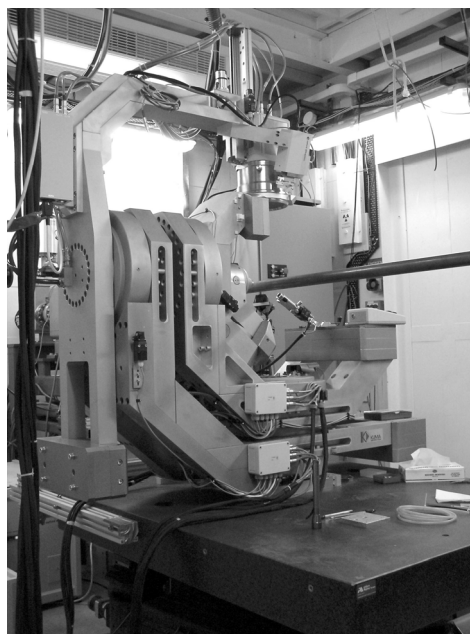
Obr. 8. 7-Kruhový monokrystalový difraktometr na linii BM01B synchrotronu ESRF v Grenoblu vhodný pro měření mikrokrystalů
