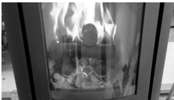
Obr. 4. Brikety staženy drátem v krbových kamnech Romotop KK 112D/AKU
