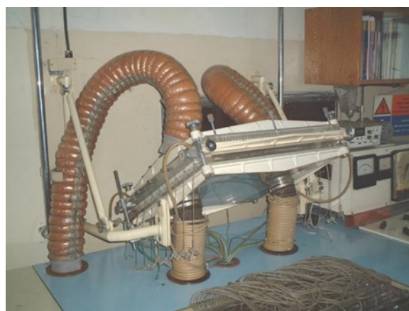
Obr. 2. Aparatura pro kontinuální průtokovou elektroforézu
