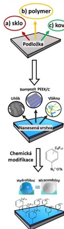
Obr. 1. Schematické znázornění přípravy vrstvy na povrchu materiálu a následného provedení chemické modifikace povrchu pomocí ADT-C 8 F 17 podle 9,13 . (Barevná verze obrázku je dostupná na webových stránkách časopisu Chem. Listy).
