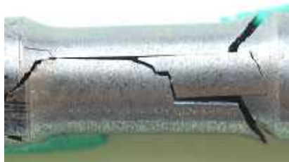
Obr. 5. Dolomenie nTi pod cca 45^\circ uhlom
