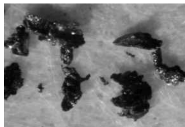
Obr. 1. Morfológia prachu z brúsenia liatinových odliatkov (zv. 10x)
