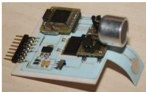
Obr. 7. Kompletne osadená elektronika pre mobilný ministro
