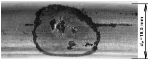
Obr. 5. Hĺbková povrchová trhlina vzniknutá pri prietlačnom lisovaní mosadze Ms70 s rýchlosťou deformácie vyššou ako 1,5 s -1
