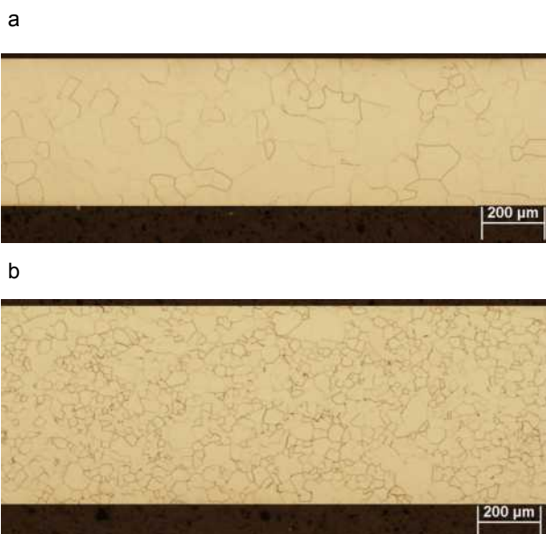
Obr. 1. Mikroštruktúra východzieho stavu ocelí a, - oceľ A, b, - oceľ B
