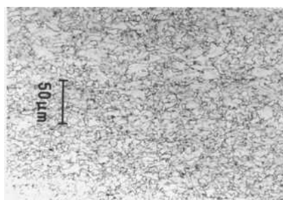
Obr. 2. Mikroštruktúra ocele S460 MC
