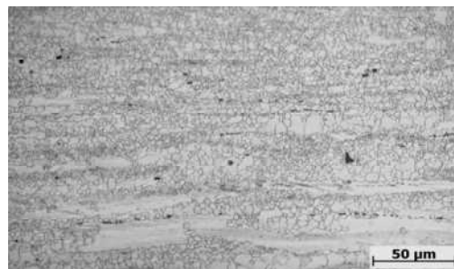
Obr. 1. Mikroštruktúra Mg zliatin AE21, lept. kyselina pikrová, svetelná mikroskopia
