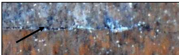
Obr. 4. Vznik prvotných trhlín na skúšobných vzorkách v smere osi vzorky, zv. 4x
