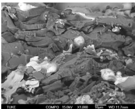
Obr. 9. Lamelárna štruktúra povlaku \text{Al}_2\text{O}_3 + 12\% \text{K30}
