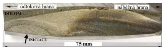
Obr. 2. Lopatka č. 509 po laboratorním dolomení
