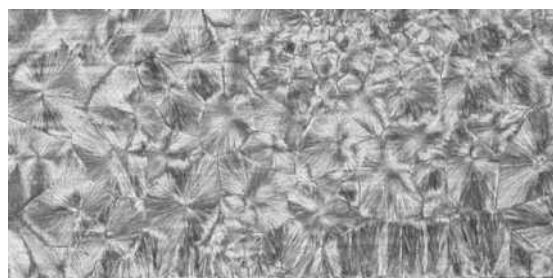
Obr. 2. Struktura vzorku 1 po tepelném zpracování. Teplota ochlazování 2 °C min -1
