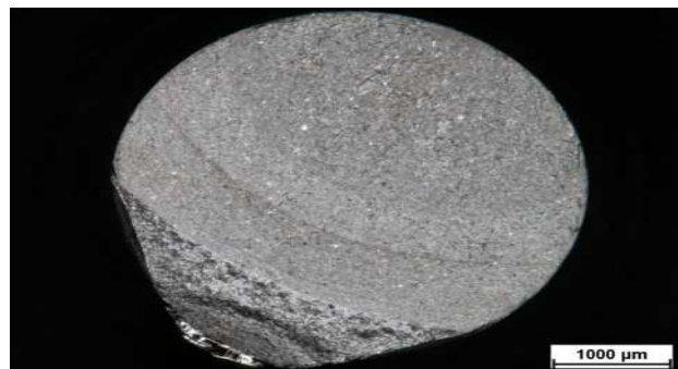
Obr. 4. Iniciačia únavového poškodenia z povrchu skúšanej tyče, ocel' AISI 316L, \sigma_a = 340 MPa, N = 33\ 712\ 110 cyklov
