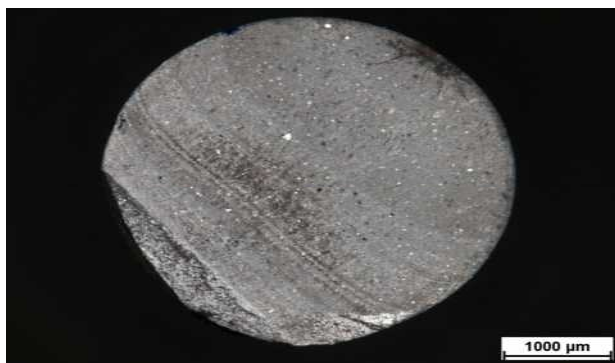
Obr. 5. Iniciácia únavového poškodenia z povrchu skúšanej tyče, oceľ AISI 316Ti, \sigma_a = 340 MPa, N = 24\,732\,100 cyklov
