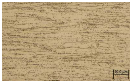
Obr. 4. Mikroštruktúra obalového plechu TS550BA
