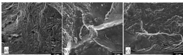
Obr. 8a. Iniciace striačním mechanismem na lopatce č. 480 Obr. 8b. Šíření trhliny interkrystalickou dekohezí na lopatce č. 459 Obr. 8c. Iniciace na interkrystalické fasetě na lopatce č. 459
