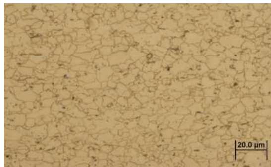
Obr. 3. Mikroštruktúra obalového plechu TH415CA
