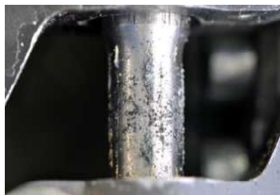
Obr. 2. Spôsob upnutia vzorky pri namáhaní v krute a tvorba viacerých trhlín titánového prášku na povrchu, zv. 4x
