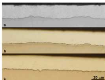
Obr. 2. Rozhranie Zn povlak – substrát (svetelný mikroskop)
