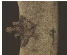
Obr. 6. Vnitřní nános ve vzorku č. 2
