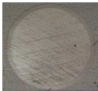
Obr. 1. Povlak CrN s hrúbkou 1,7 \mu\text{m}
