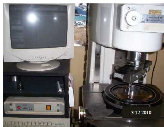
Obr. 2. Meranie ovality na meracom zariadení Talyrond 73
