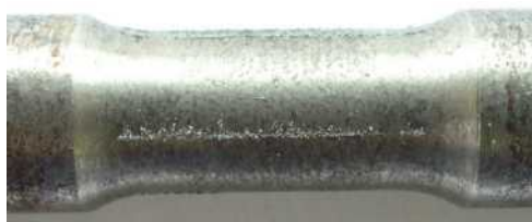
Obr. 1. Tvar skúšobnej tyče s trhlinou pokrytou titánovým práškom na jej povrchu, zv. 4x
