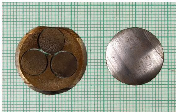
Obr. 5. Odobratá vzorka po elektroiskrovom delení
