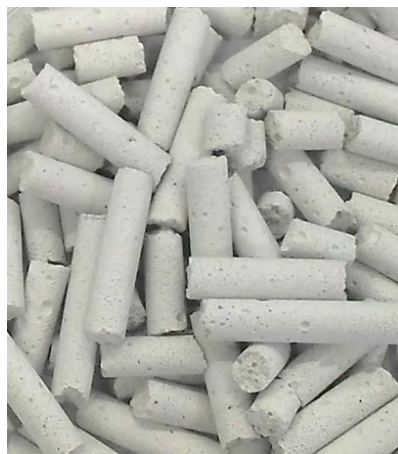
Obr. 2. Připravené pelety zeolitové pěny
