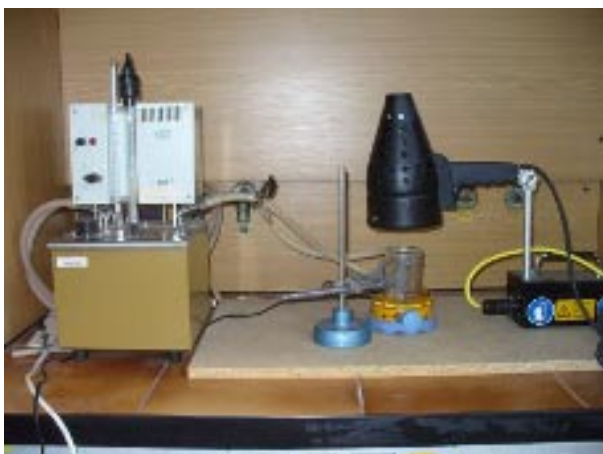
Obr. 5. Zařízení k testování fotoindukovaných samočisticích vlastností materiálů měřením fotokatalytického rozkladu Acid orange 7 s chlazením v temperované komůrce
