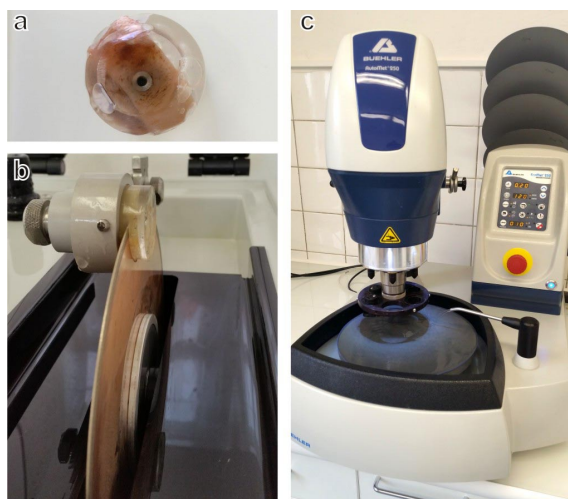
Obr. 3. Postup zpracování vzorku , a) bloček kosti s implantátem zalitý do bloku, b) řezání tenkých plátků na pomaloběžné pile s diamantovým kotoučem, c) broušení a leštění výbrusů na poloautomatizované brusce
