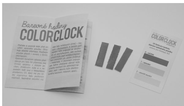
Obr. 8. Spotřebitelský formát dozimetrů pro bezpečnější opalování. Zprava – etalon pro kvantifikaci barevné změny, vlastní dozimetry nanosené na fólii opatřené lepicí vrstvou na rubové straně a dále návod na použití
