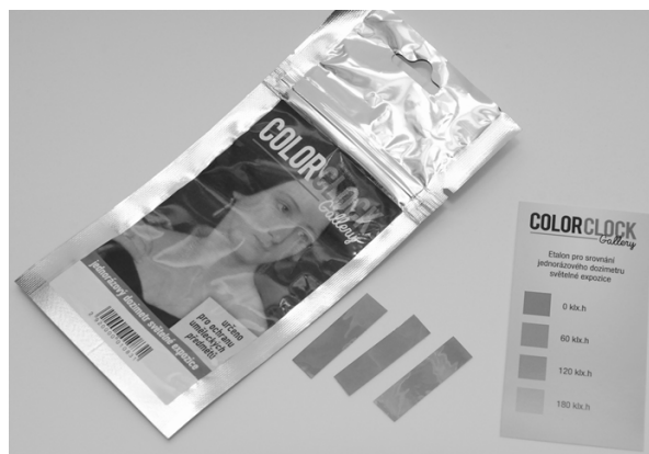
Obr. 10. Balení galerijního dozimetru (maximální osvit 180 klx h) v konečné uživatelské podobě
