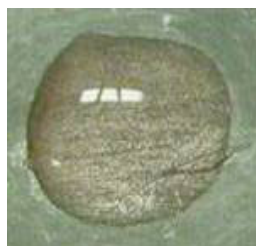
Obr. 7. Kapkový experiment po 15 min, uhlíková ocel, dusík , 30 \text{ g l}^{-1} \text{ NaCl} , bromthymolová modř ( 0,4 \text{ g l}^{-1} ), 2,2'-bipyridyl ( 0,5 \text{ g l}^{-1} )
