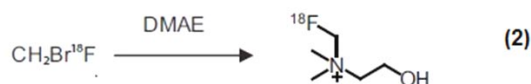
Obr. 2. Schéma syntézy ^{18}\text{F} fluorocholinu. Fáze (1) probíhá na destilačním IFP na modulu č.1, fáze (2) na alkylačním IFP na modulu č. 2. K.2.2.2. – 2,2,2-kryptand, DMAE – dimethylaminoethanol
