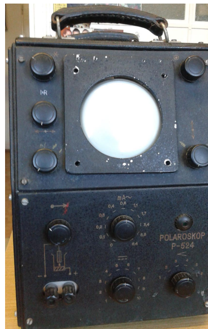
Obr. 1. Polaroskop P 524 vyrobený firmou Křižík, Praha
