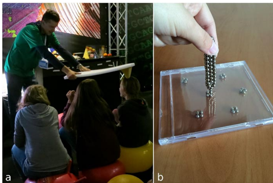
Obr. 4. Modely sondy SPM. a) Model raménka AFM s hrotem a jeho demonstrace na výstavě Mikroskopie hrou. b) Model sondy STM, coby nanomanipulátoru, sestavený z magnetických kuliček
