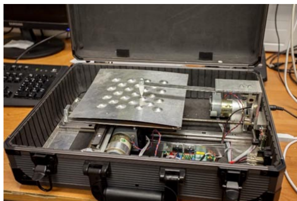
Obr. 2. Brněnský „Makroskop“, tj. makroskopický model AFM
